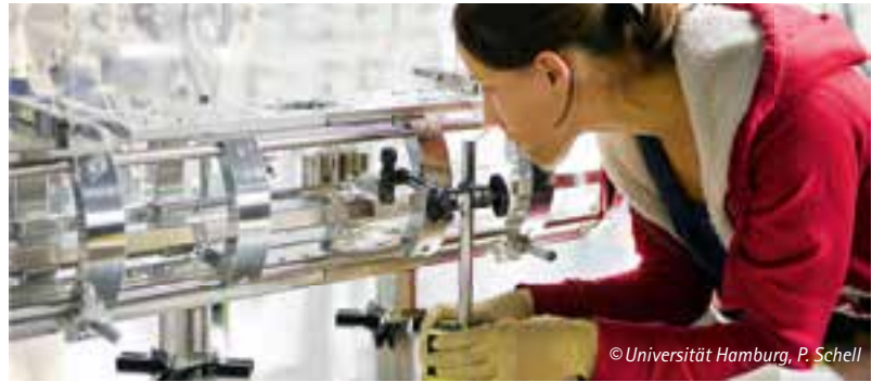
Innenaufbau einer Vakuumkammer zur Fokussierung von Molekülen.
